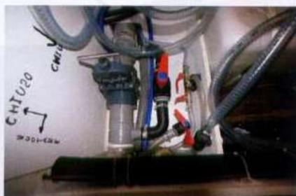
Nel vano impianti la pompa che permette il passaggio da un ballast all'altro e lo scarico dell'acqua. L'operazione richiede circa 15 secondi. In questo vano anche il serbatoio carburante (standard da 60 lt). Opzionale il riscaldamento accoppiato al motore e il boiler.
