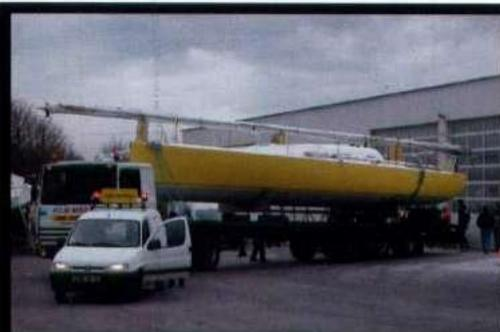
Coperta e scafo vengono assemblati; la chiglia viene infilata nella scassa a cui verrà fissata, il Pogo 40 è pronto per essere trasportato al porto per il varo.
