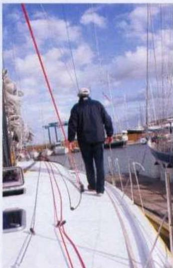
**Larghi i passavanti;** sul bordo corre per tutta la lunghezza un **puntapiedi**. Sotto, il carrello del fiocco e un dettaglio del **barber**. Volendo è possibile montare un carrello trasversale invece di quello longitudinale.
